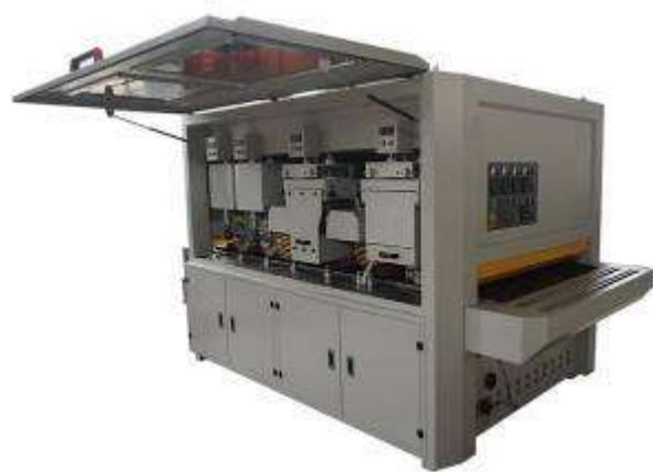
شكل رقم ( 10 ) ماكينة التنعيم و الترميل Brushing Sanding Machine
